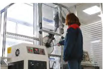
冲击试验(最低试验温度:-196°C)
